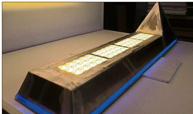
Leuchtenkopf mit LED-Modulen und hinterleuchtetem Acrylglas.
