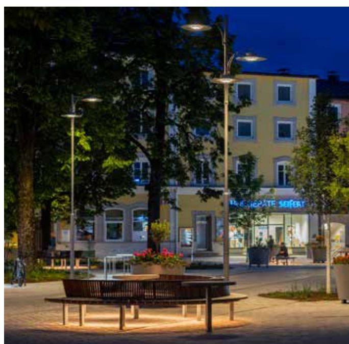
Abbildung 2: Die Betriebsgeräte der indirekten Effektbeleuchtung der Bänke wurden in den Leuchtenmasten unterbracht.
